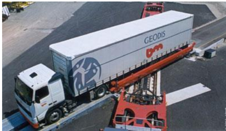
Slika 14 Bočni ukrcaj Modalohr tehnologija
