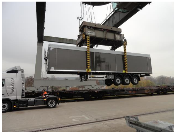
Slika 11 Huckepack tehnologija B, vertikalni utovar
