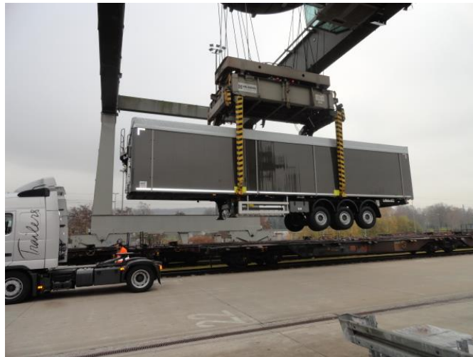
Slika 11 Huckepack tehnologija B, vertikalni utovar
