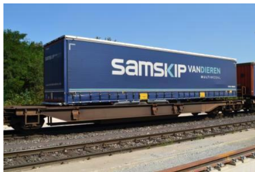
Slika 12 Huckepack tehnologija C
