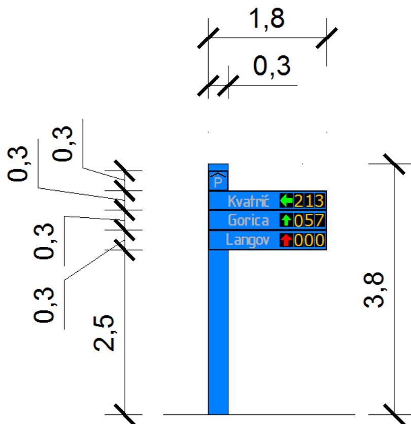
Ovisno o sustavu povezivanja sa centralnim računalnim sustavom u stupu je sa stražnje strane servisni ormarić u koji se postavlja GPRS modem ili optički kabeli sa opremom za napajanje. Tako se osigurava lakši pristup tehničarima radi održavanja ili otklanjanja kvara uz minimalno ometanje prometnih, pješačkih ili biciklističkih tokova.
