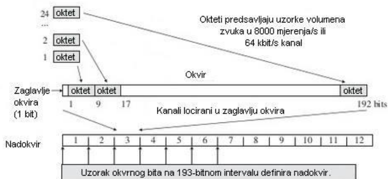
Slika 1. Formiranje TDM okvira. Preuzeto od [1].
