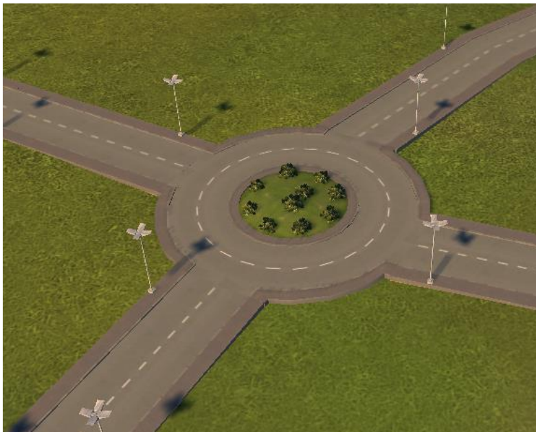
Slika 15. Rasvjeta na produžetku tangente na simetralu ceste
