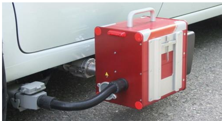
Slika 28. Prikaz dinamičkog retroreflektometra
