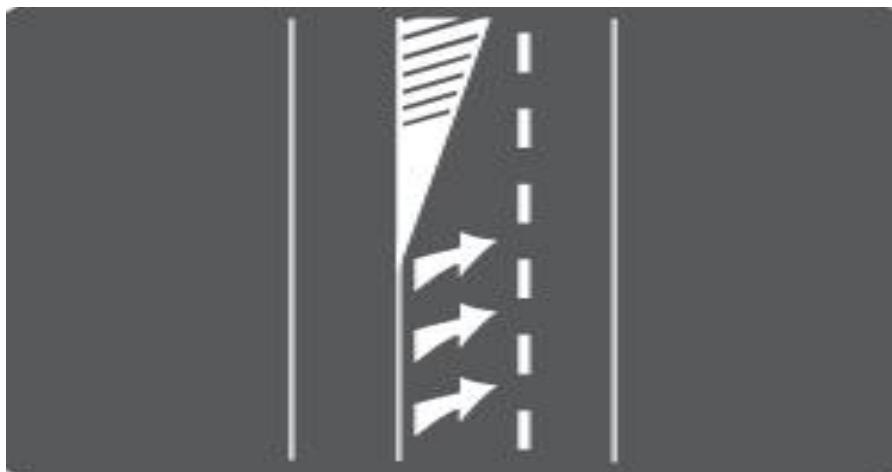
Slika 22. Crte usmjeravanja za označavanje promjene korisne površine kolnika (H37)[3]
