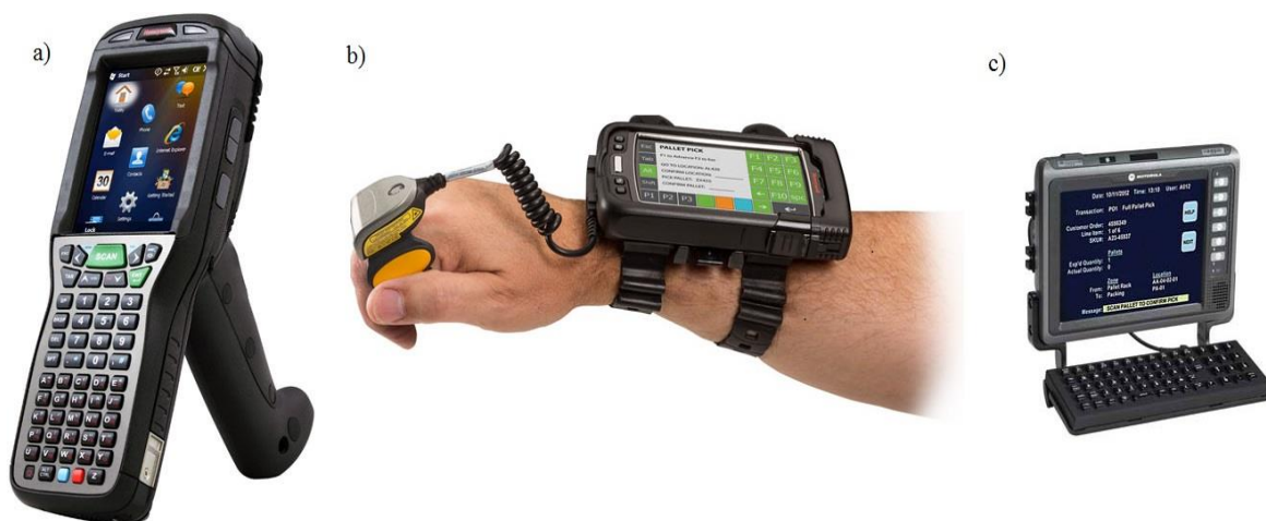
Slika 4 Prikaz: a) ručnog terminala, b) nosivog terminala sa prstnim skenerom i c) terminala za montiranje na transportno manipulativno sredstvo
