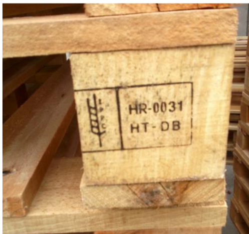
Slika 9: Oznaka termički obrađene palete
