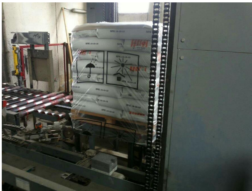
Slika 19: Folija se navlači na paletu
