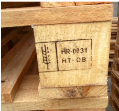
Slika 9: Oznaka termički obrađene palete
