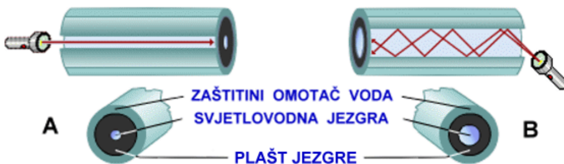
Slika 5. Optičko jednomodno i višemodno vlakno
