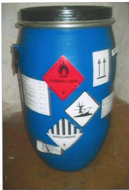
Slika 21. Spremnik za zapaljive tekućine
