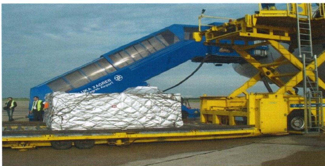
Slika14. Highloader Izvor: Arhiva Zračne luke Zagreb
