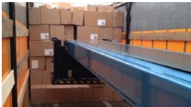
Slika 13: Prikaz produžnog transportera u kontejneru
