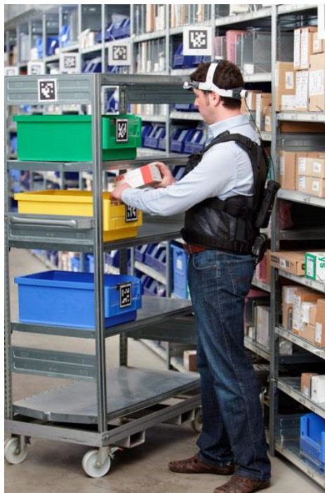
Slika 38. Tehnologija vizualnog prepoznavanja proizvoda
