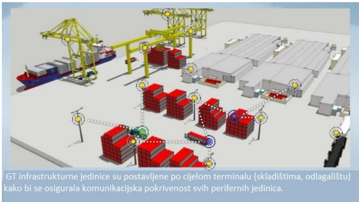
Slika 27. GT infrastrukturne jedinice na terminalima i skladištima
