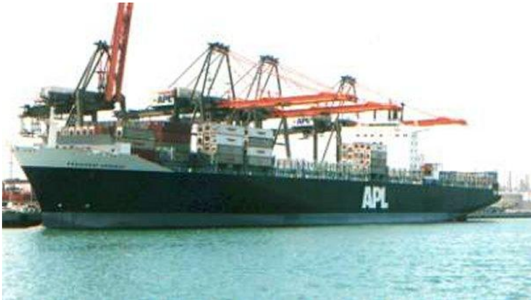
Slika 5 APL C10 - prvi izgrađen kontejnerski brod Postpanamax generacije
