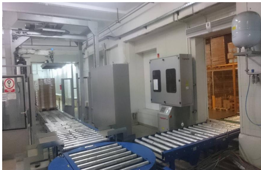
Slika 7. Transporter sa rolama za repromaterijal i prijenos gotovih proizvoda
