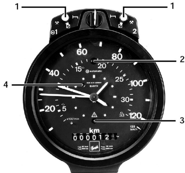
Slika 4. Primjer analognog automatskog tahografa starije generacije sa mogućim pristupom pisačima
