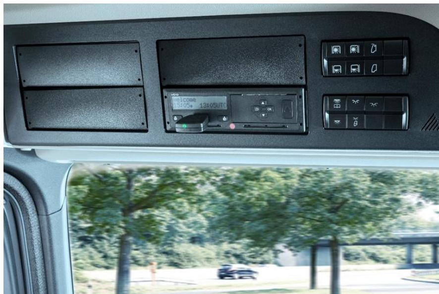
Slika 8. VDO Digitalni tahograf – uređaj u vozilu
