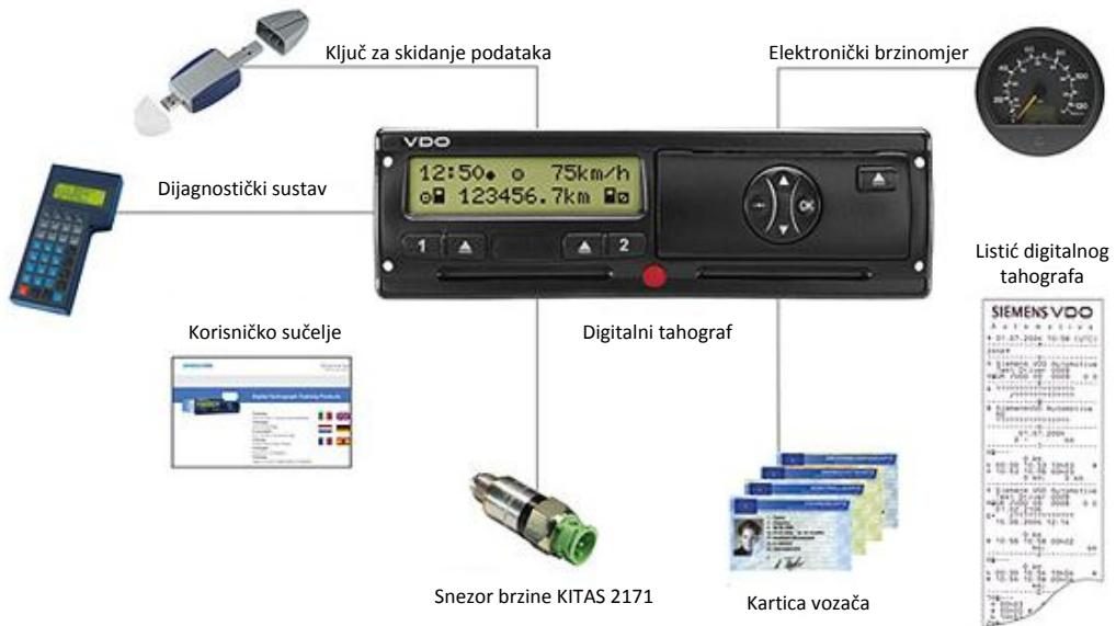
Slika 27. Slika prikaza digitalnog tahografskog sustava
