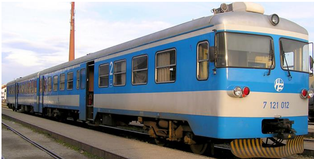
Slika 10. Dizel-motorni vlak serije 7121
