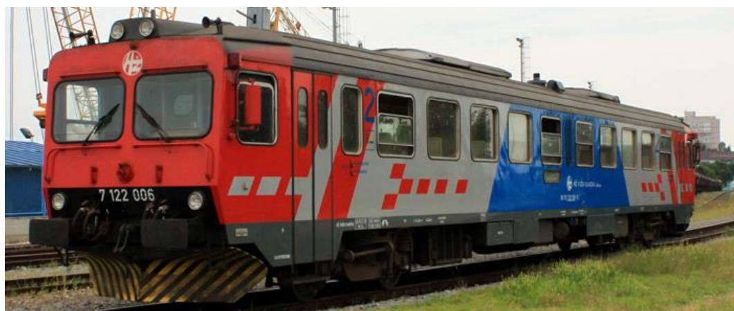
Slika 11. Dizel-hidraulički vlak serije 7122
