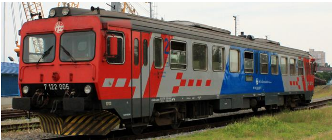
Slika 11. Dizel-hidraulički vlak serije 7122
