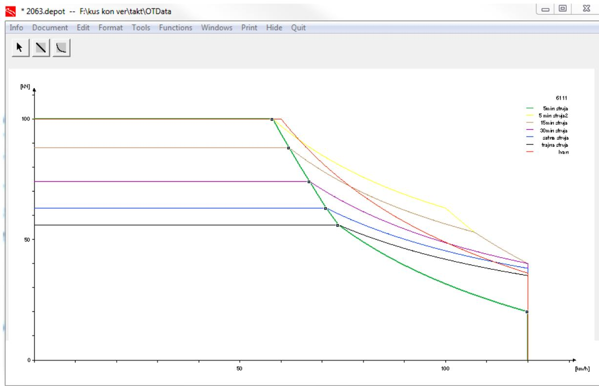
Slika 3.14. Vučni pasoš elektromotornog vlaka serije 6111
