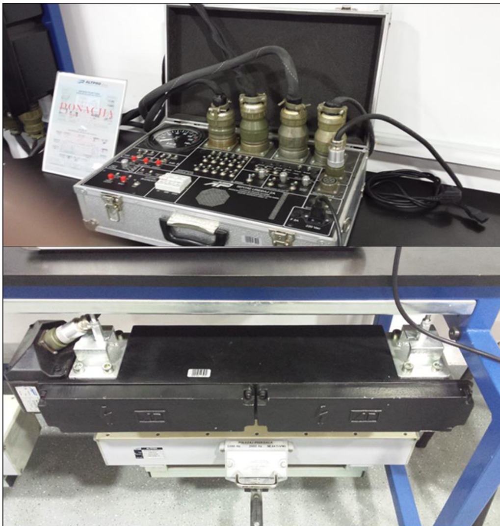
Slika 12. Postupak izvođenja simulacija pomoću ispitnog uređaja ASI
