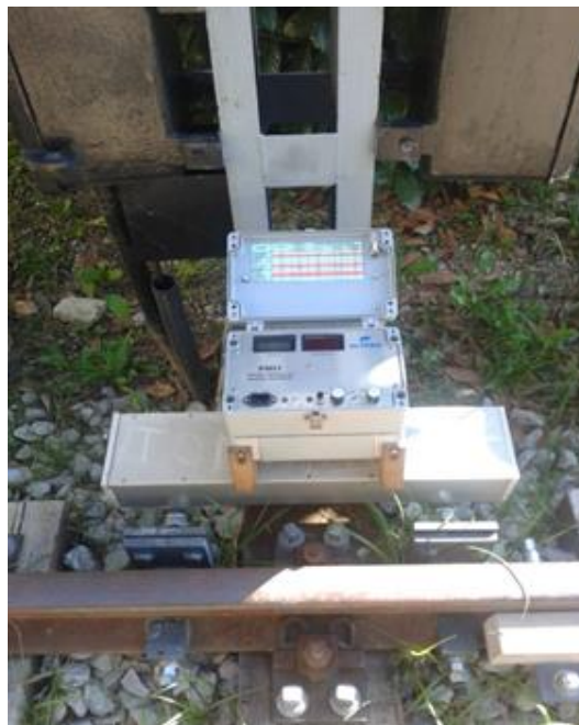
Slika 11. Ispitni uređaj za pružne balize tipa PMI2
