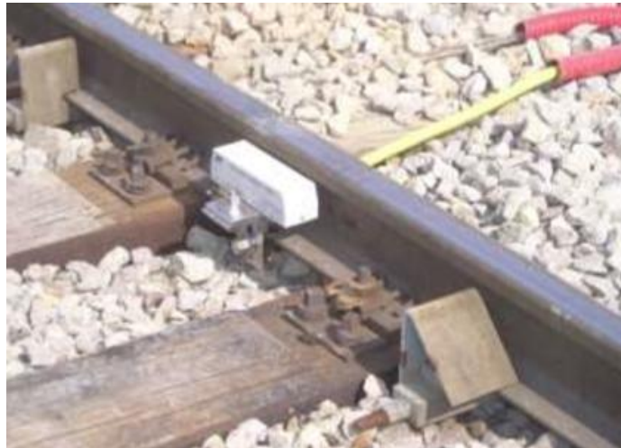
Slika 4. Senzor ZK24-2 na nosaču montiran uz tračnicu sa pripadajućim štitnicima [2].
