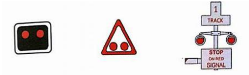
Slika 8. Prikaz svjetlosnih cestovnih signala prema različitim propisima [6].
