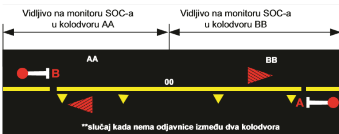
Slika 4: Slučaj kada nema odjavnice između dva kolodvora
