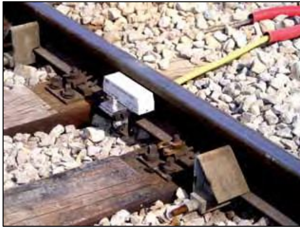
Slika 12: Prikaz senzora željezničkog kotača ZK24-2
