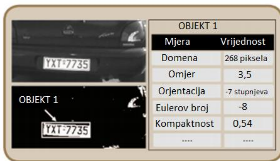
Slika 8. Oblik analize u binarnom objektu[13]
