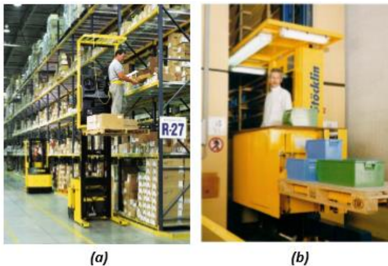
Slika 10: Prikaz viljuškara za komisioniranje u vertikalnoj ravnini (a) i čovjek na AS/RS uređaju man-on-board (b)
