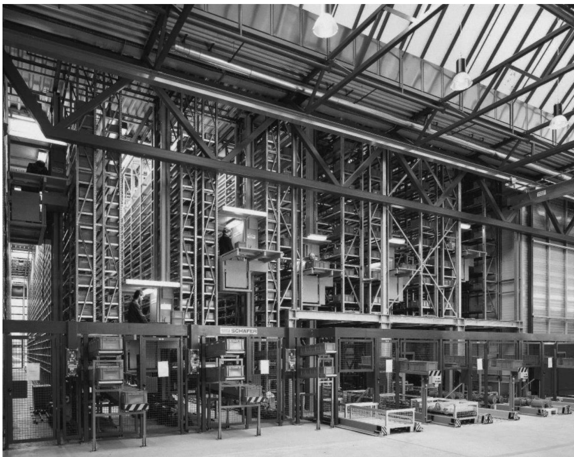
Slika 19.: Person on board AS/RS sustav Izvor: [7]
