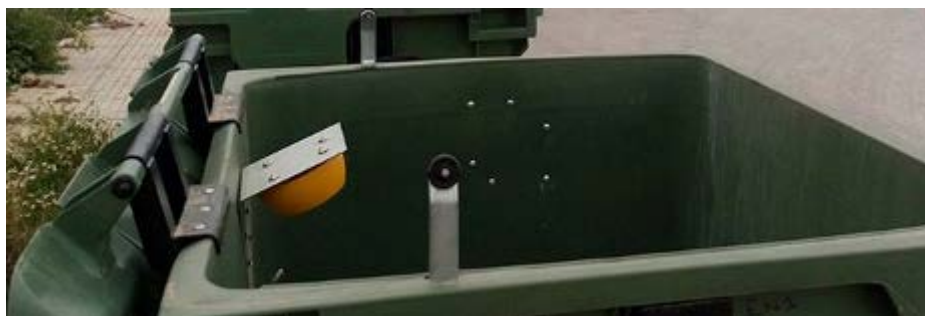
Slika 34: Prikaz senzora popunjenosti kontejnera tvrtke Enevo
