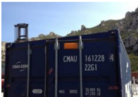
Slika 24: TRAXENS kutija sa senzorima na kontejneru tvrtke CMA CGM Izvor: https://mpoverello.com/tag/container-tracking/ (kolovoz, 2016)
