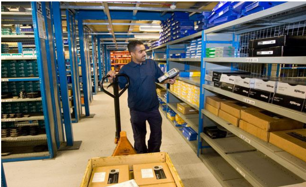
Slika 15. Komisioniranje uz pomoć bar kod čitača
