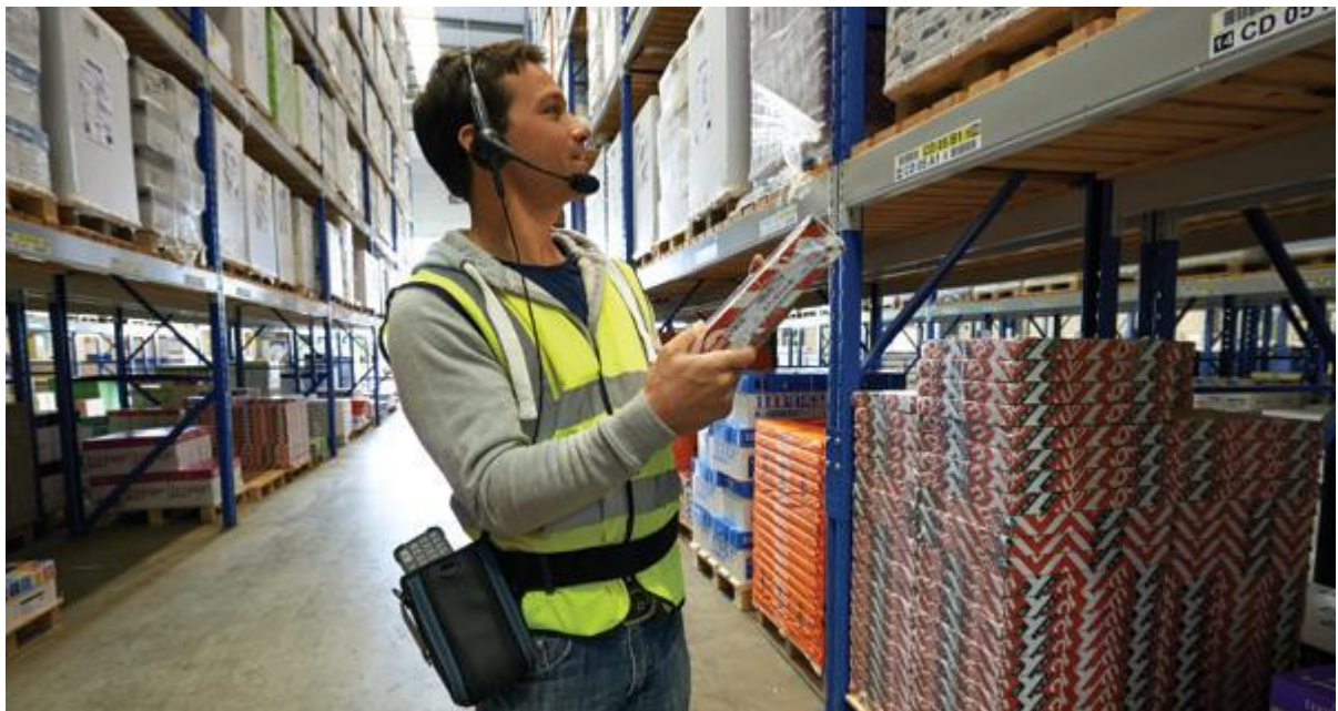
Slika 16. Komisioniranje uz pomoć glasovnih naredbi
