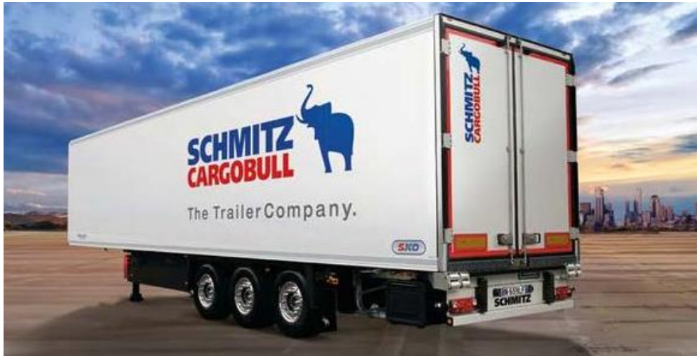
Slika 5. Poluprikolica s toplinski izoliranom nadogradnjom i uređajem za hlađenje
