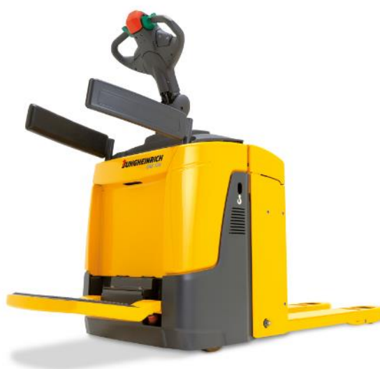
Slika 9. Ručni baterijski viličar marke Jungheinrich
