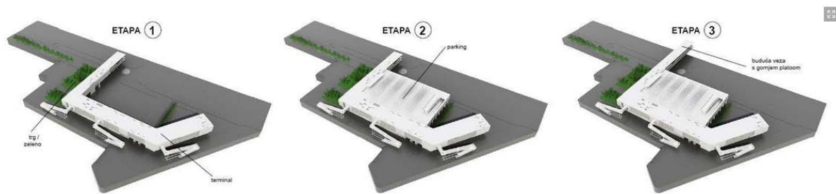
Slika 19. Etape izgradnje zgrade terminala
