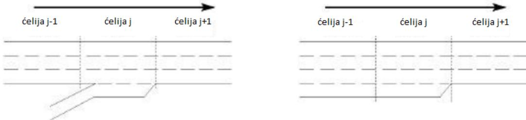
**Slika 3.** Priključivanje upravljanog priljevnog toka na glavni tok i završetak prometne trake na autocesti, [10]
