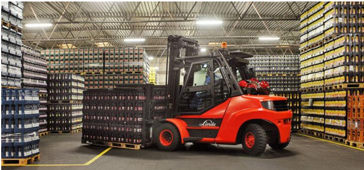
Slika 6. Primjer prekrajne mehanizacije u skladištu; [9]
