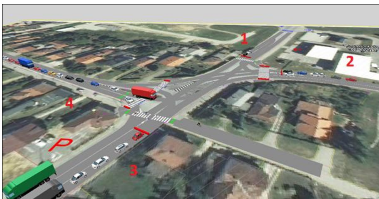
Slika 7.1. Izvođenje simulacije postojećeg stanja u Vissim-u
