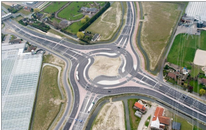
Slika 2.1. Prikaz turbo kružnog raskrižja u Brielleu, Nizozemska [5]
