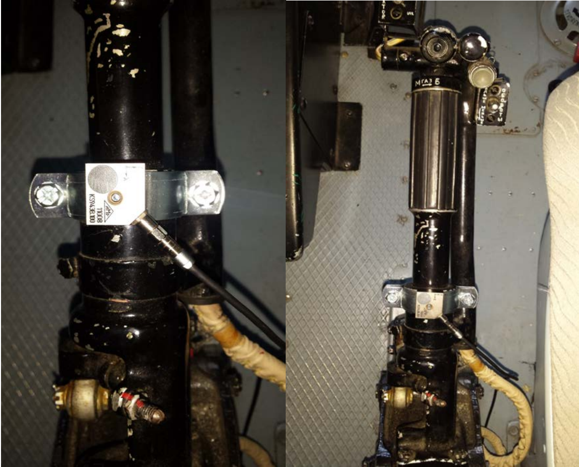
Slika 50. Troosni akcelerometar postavljen na kolektivnoj palici
