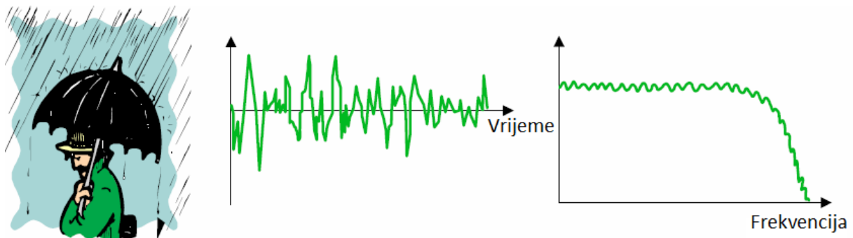
Slika 12. Primjer slučajnog signala
