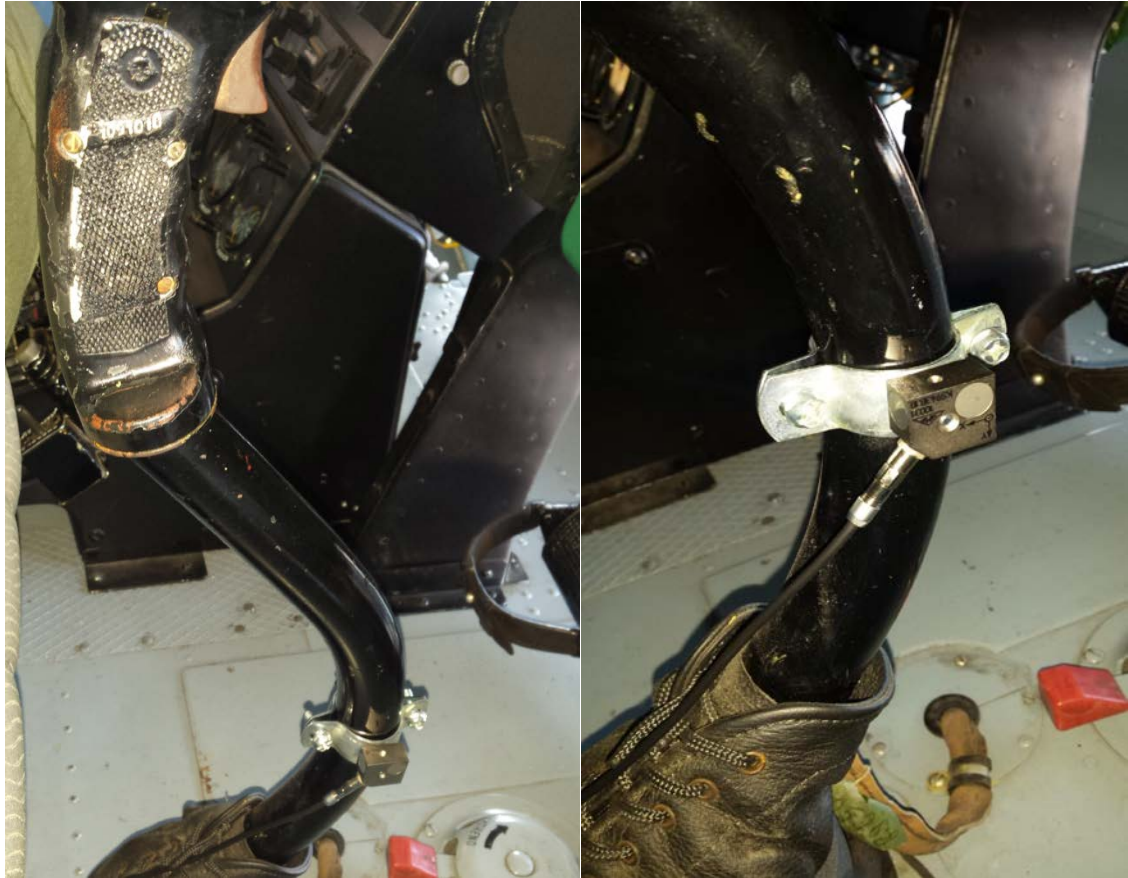
Slika 49. Troosni akcelerometar postavljeni na cikličnoj palici
