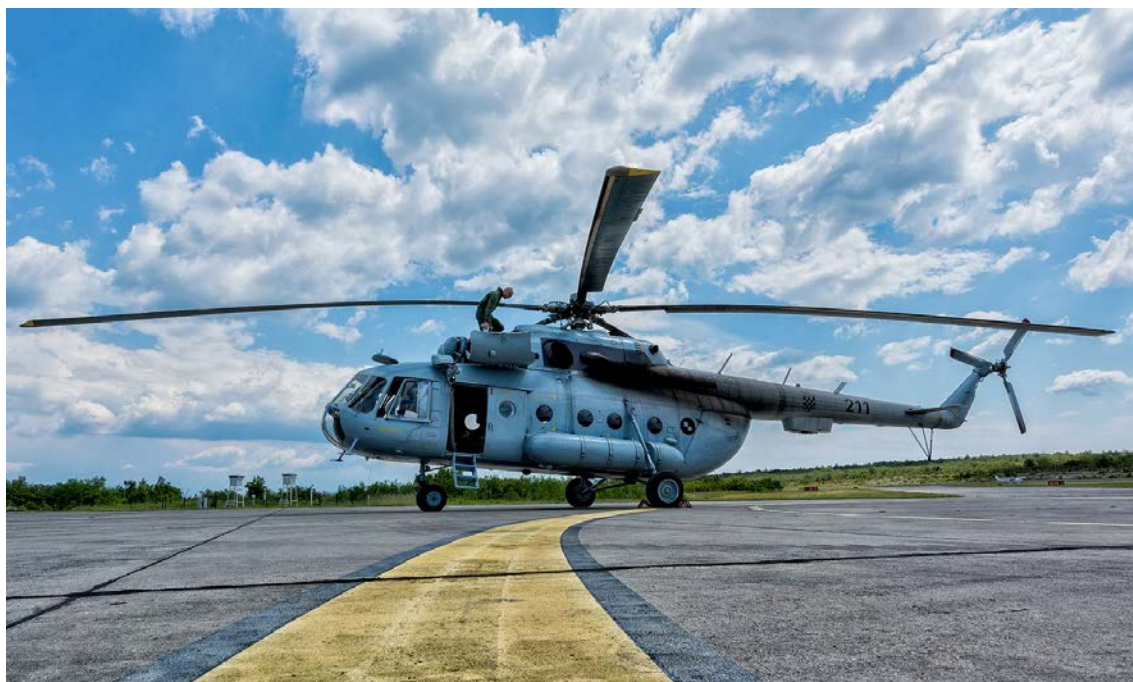
Slika 48. Helikopter Mil Mi-8 MTV-1 registrarske oznake H-211, koji nema ugrađen ublaživač vibracija
