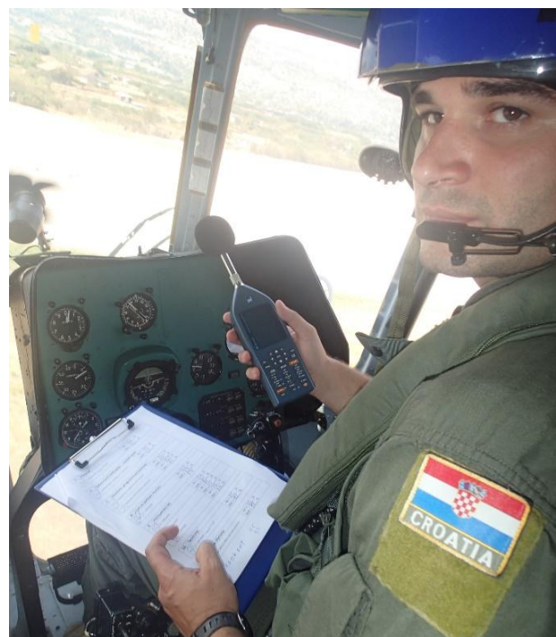
Slika 23. Analizator zvuka Norsonic nor140 [13] i mjerenje u letu
