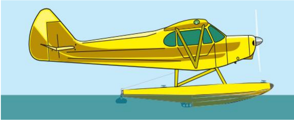
Slika 8. Položaj zrakoplova u praznom hodu [7]
