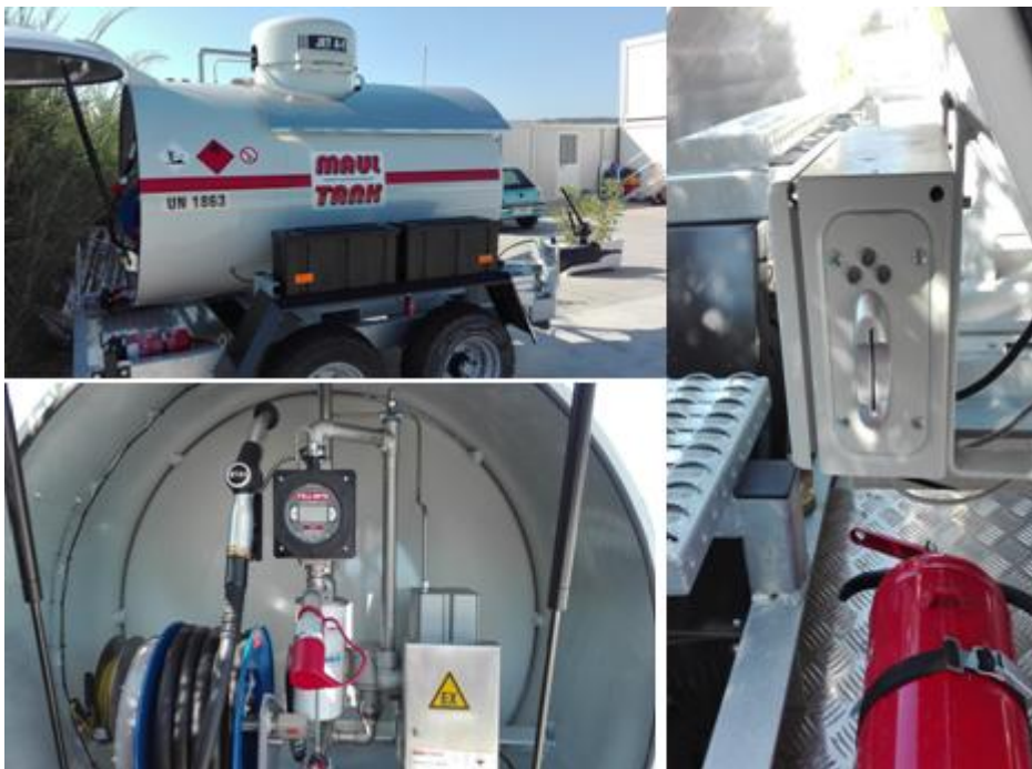
Slika 22. Cisterna za opskrbu hidrozrakoplova gorivom
