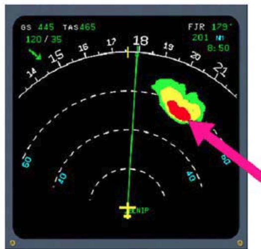
Slika 18. Nagla promjena intenziteta meteorološke pojave
