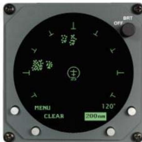
Slika 20. Prikaznik detektora elektrostatičkog pražnjenja *Stormscope*
