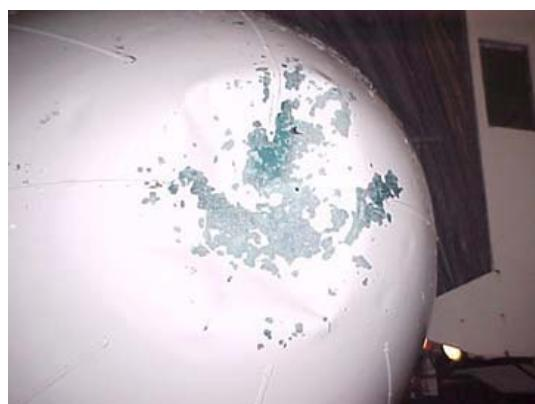
**Slika 8. Šteta na zrakoplovu zbog tuče**
