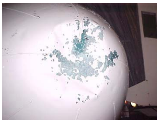
Slika 8. Šteta na zrakoplovu zbog tuče
