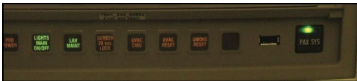
Slika 20. Prikaz komande za poništavanje upozorenja [1]
