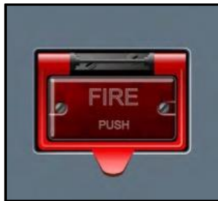
Slika 12. Prikaz FIRE kontrole u normalnom stanju [1]
