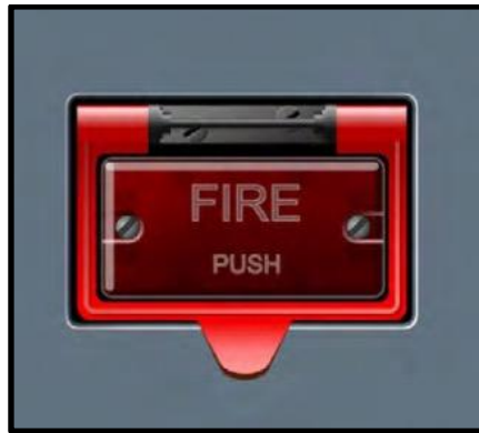
Slika 6. Prikaz FIRE komande u normalnom položaju [1]
