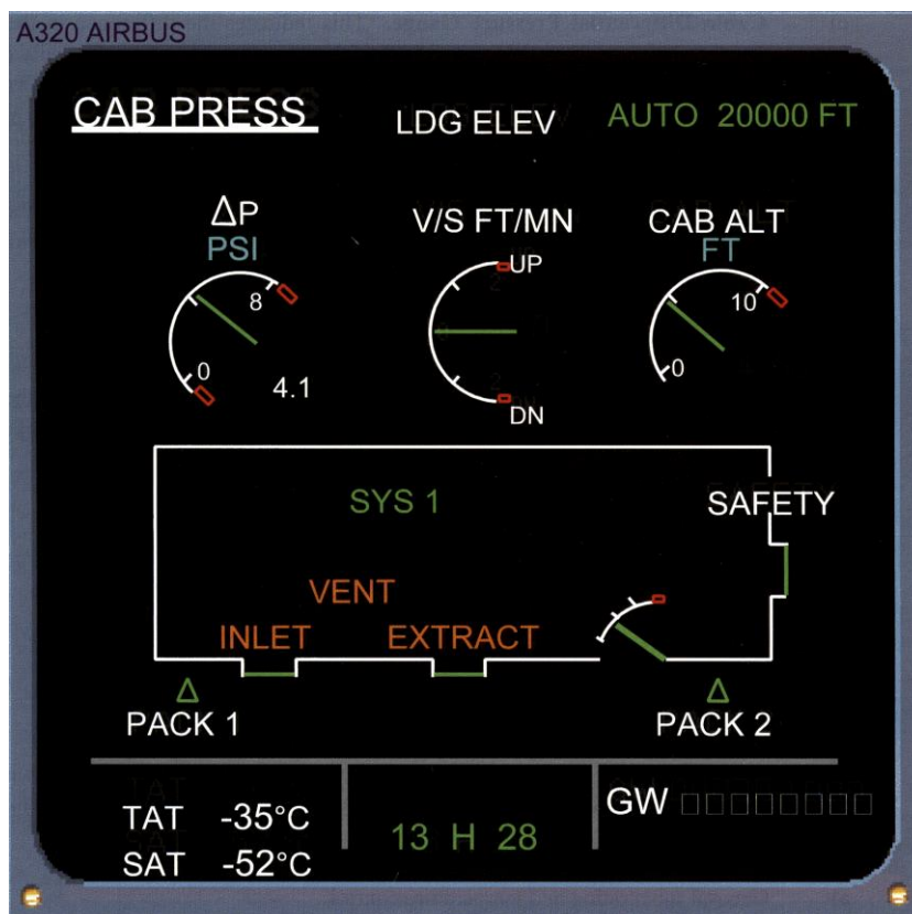
Slika 4.6. Prikaz sustava nadtlučivanja kabine zrakoplova na ECAM-u
