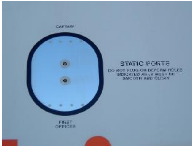
Slika 2. Statički otvori na trupu zrakoplova-Boeing 737 [5]
