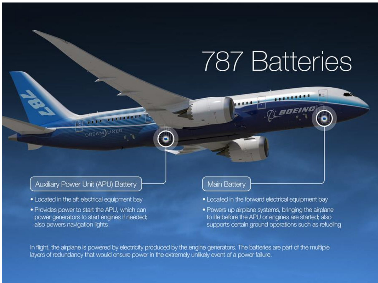
Slika 9: Smještaj baterija na B787, izvor: http://787updates.newairplane.com/787-Electrical-Systems/Batteries-and-Advanced-Airplanes
