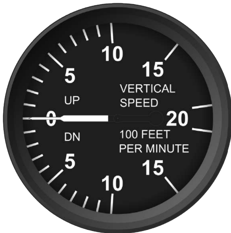
Slika 23. Izgled prikaznika standardnog variometra
