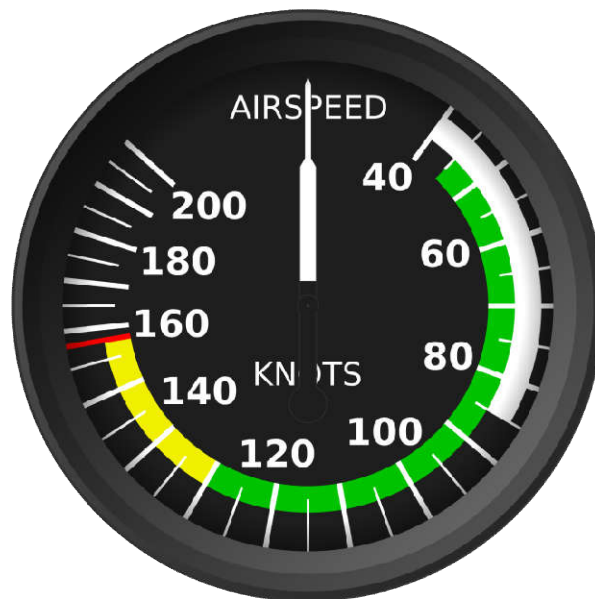
Slika 20. Izgled mehaničkog prikaznika indicirane brzine (IAS)
