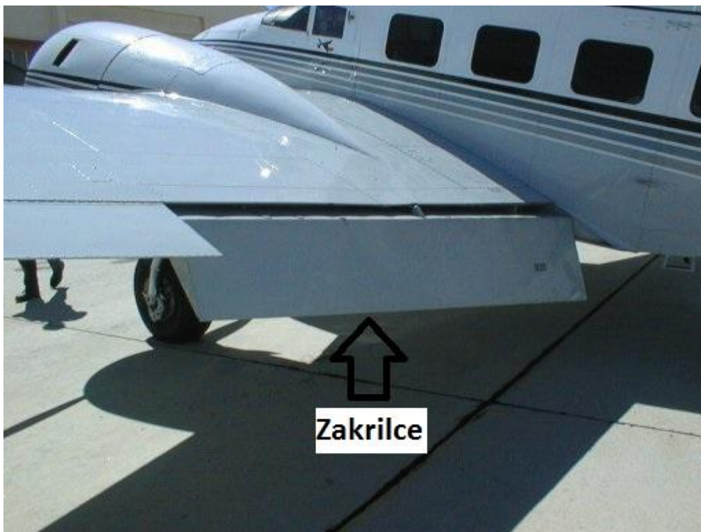
Slika 11 - Obično zakrilce na zrakoplovu Beech E-18S Super 18 [10]
