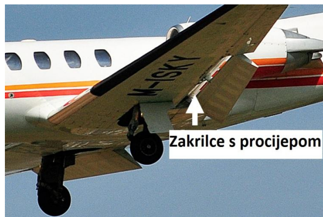
Slika 15 - Zakrilce s procijepom na zrakoplovu [12]
