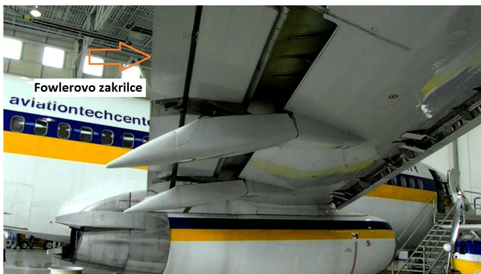
Slika 17 - Boeing 747 sa Fowlerovim zakrilcem
