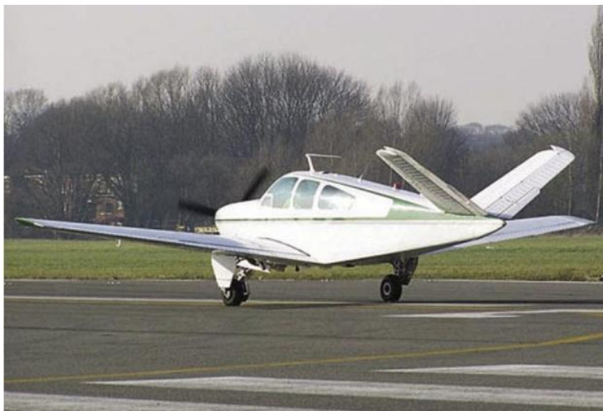
Slika 28 - Prikaz V repa na zrakoplovu Beechcraft Bonanza V35 [3]
