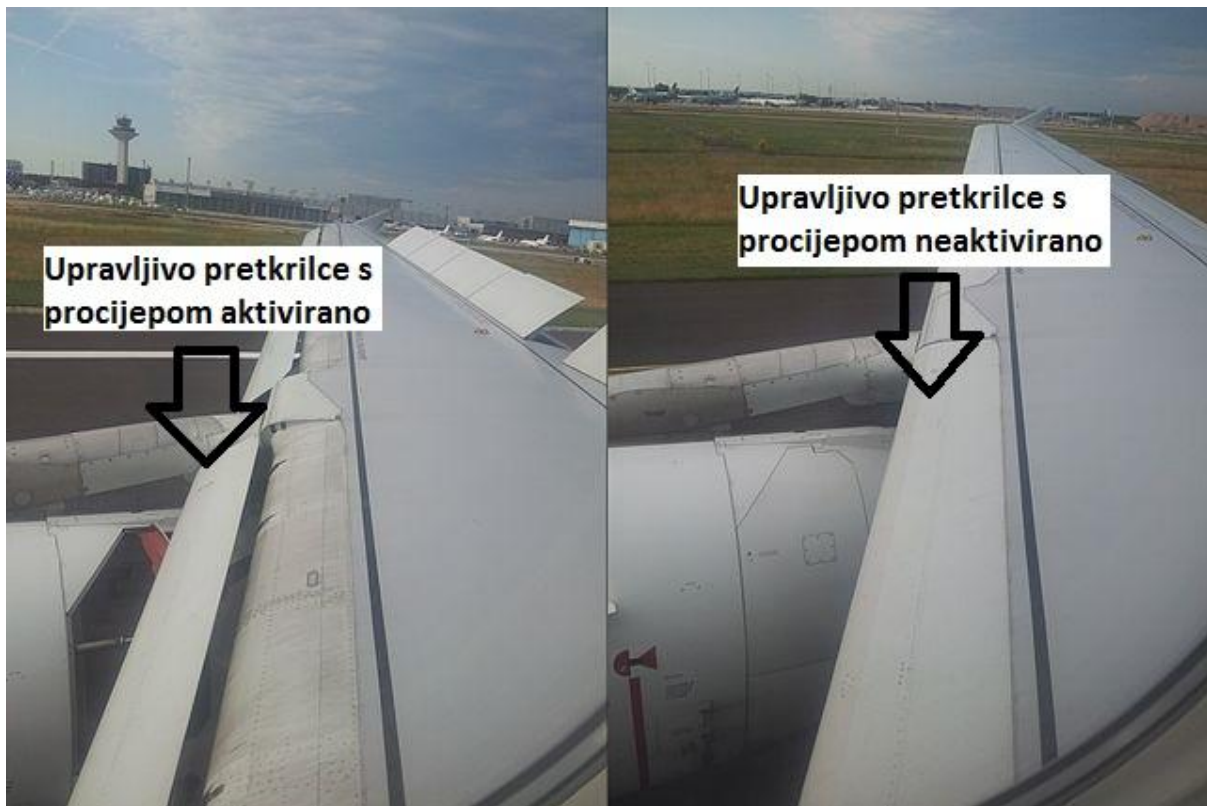
Slika 23 - Upravljivo pretkrilce s procijepom na zrakoplovu Airbus A319
