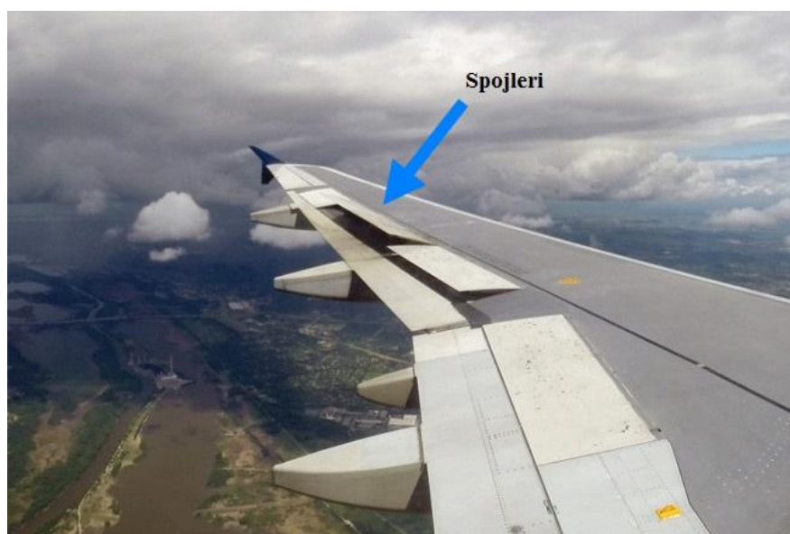
Slika 26 - Aktivirani spojleri na zrakoplovu A320
