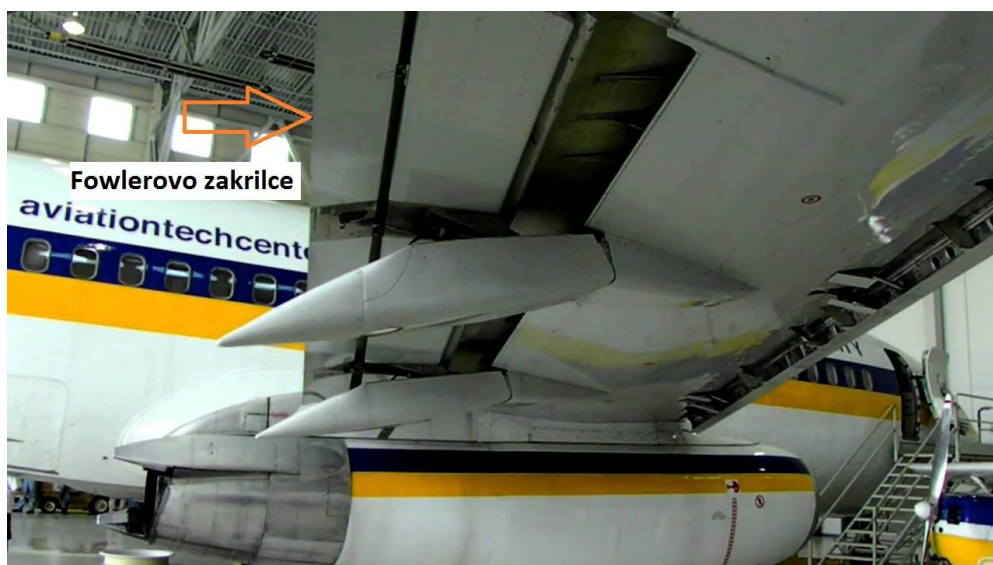
Slika 17 - Boeing 747 sa Fowlerovim zakrilcem
