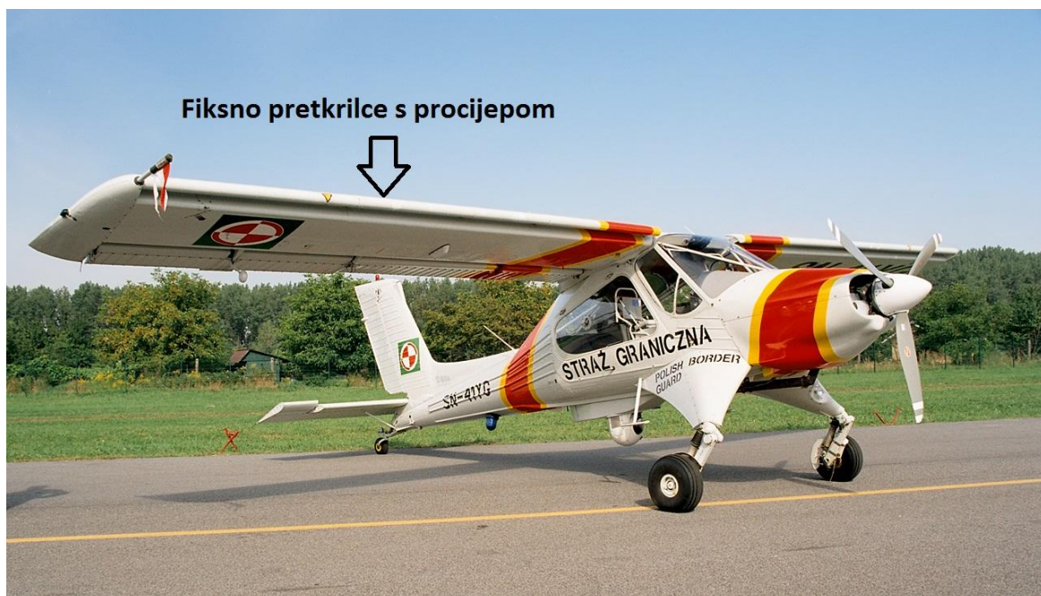
Slika 21 - Fiksno pretkrilce s procijepom na zrakoplovu PZL-104M Wilga 2000
